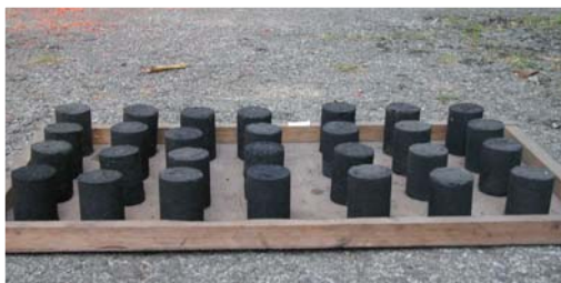
Gambar 1. Proses penjemuran briket arang sekam di bawah sinar matahari
