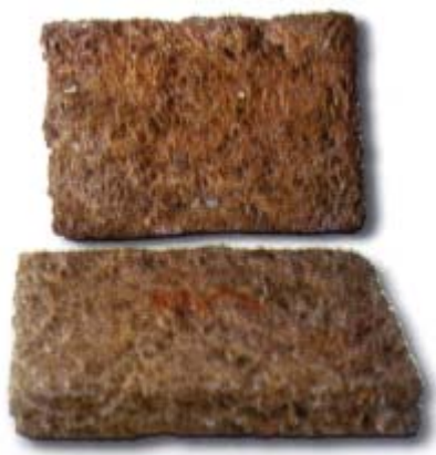
Sebutret, serat sabut kelapa berkaret untuk pelapis bagian atas per pada kasur pegas dan jok mobil.
